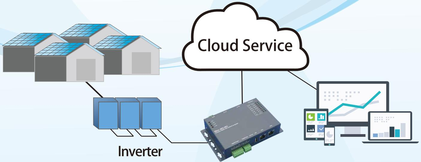
將太陽能發電的狀態訊息傳送到雲端主機，提供即時的發電數據與長期紀錄，透過雲端服務即可掌握各電廠的發電情形。
