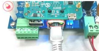
接上網路線及電源後，請確認電源指示 LED 及網路指示燈是否有亮(紅圈處)
