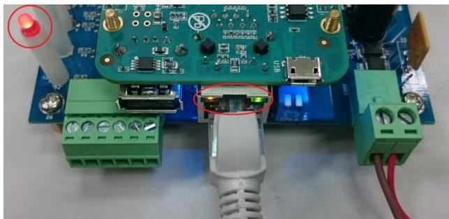
硬體接上線後，需注意電源指示 LED 燈以及網路指示燈是否有亮，紅圈處
